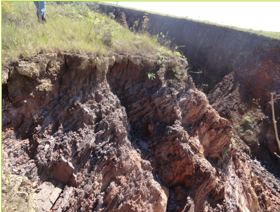
Figura 73: Filito típico da Formação Fecho do Funil, visualizado no interior de voçorocas, por sua vez localizadas em terrenos vizinho à área alvo. Fonte: MDGEO, 2016.
