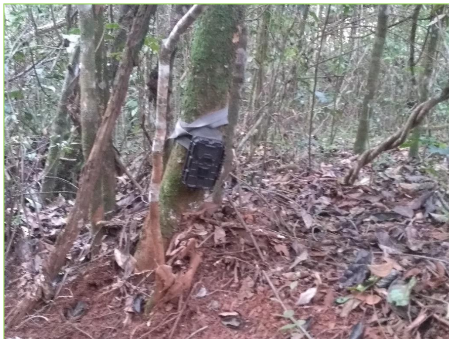
Figura 39: Câmera Bushnell modelo Trophy Cam HD instalada
