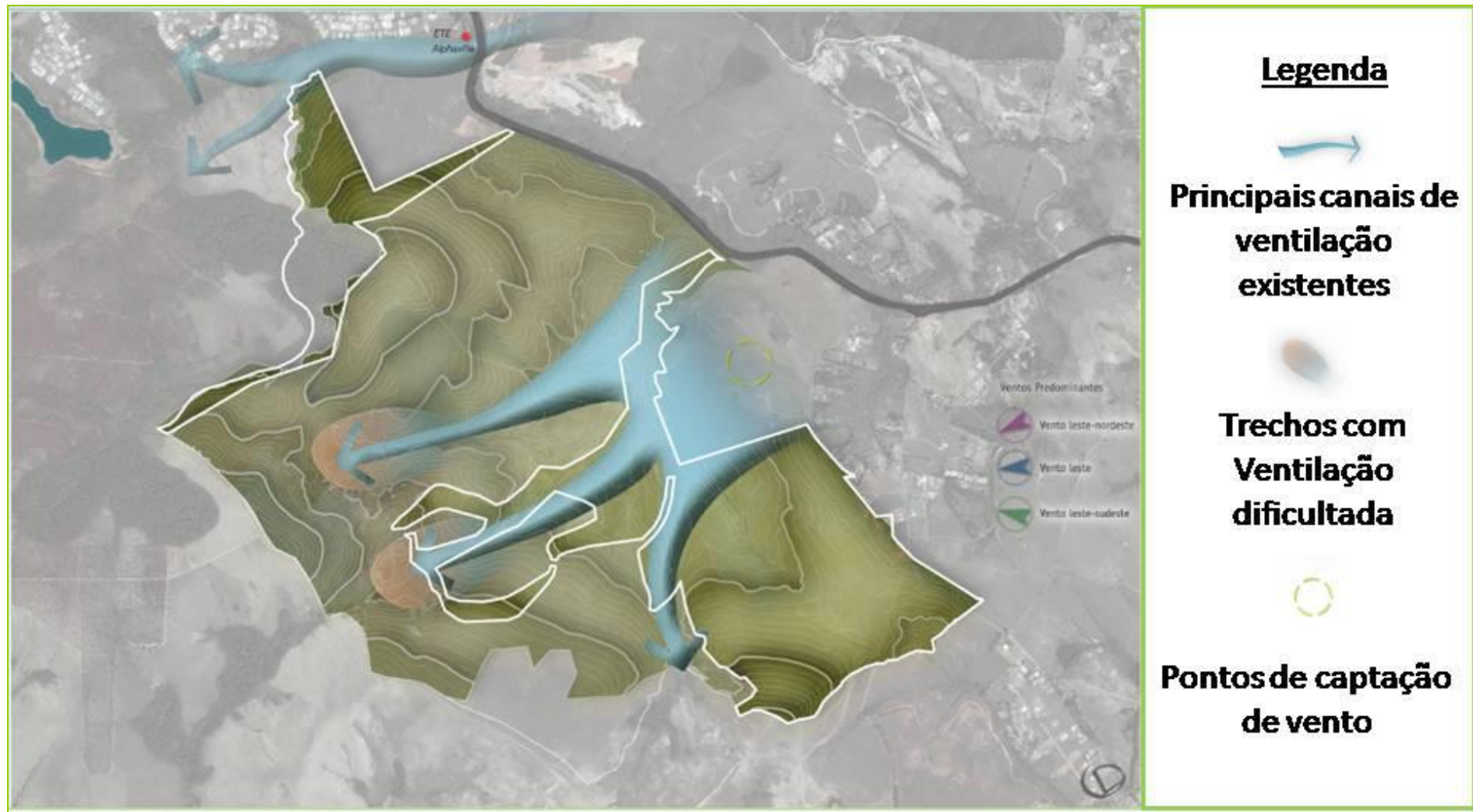
Figura 61: Mapa de ventilação local. Fonte:GPA&A(dados de pt.windfinder -06/2013 -12/2013), adaptado por Virtual Engenharia Ambiental, 2015
