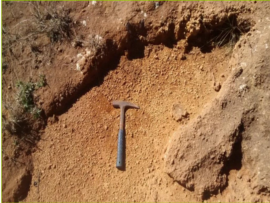
Figura 92: Carapaça laterítica dura. Solo residual altamente competente.
